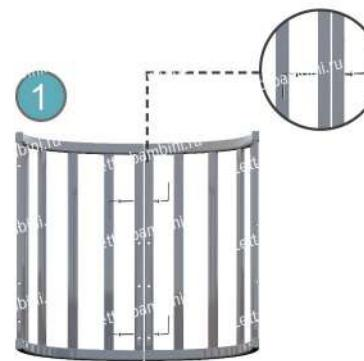
1. Соединяем две дуговые секции стяжками «С» и «D» сверху и снизу.
