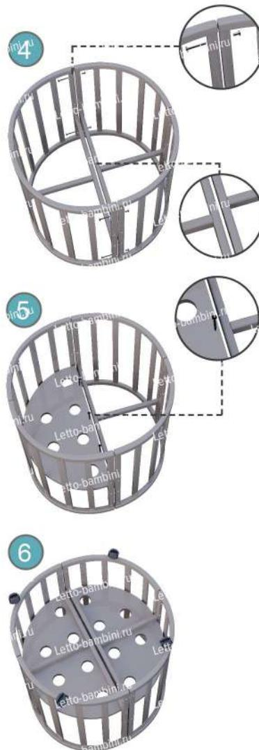
4. Соединяем половинки колыбели между собой, сверху и снизу, при помощи стяжек «С» и «Д», как показано на рисунке.
