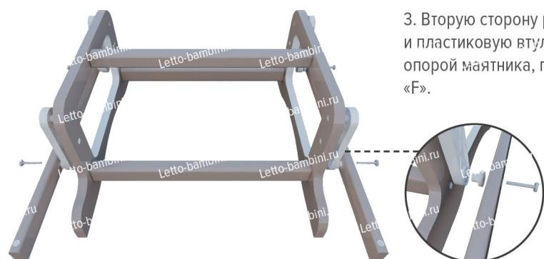
3. Вторую сторону рычага механизма и пластиковую втулку соединяем с опорой маятника, при помощи стяжки «F».
