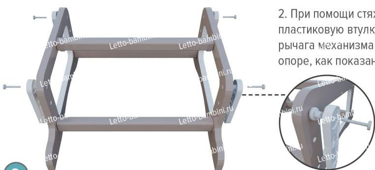
2. При помощи стяжки «F» фиксируем пластиковую втулку и одну сторону рычага механизма к Д-образной опоре, как показано на рисунке.
